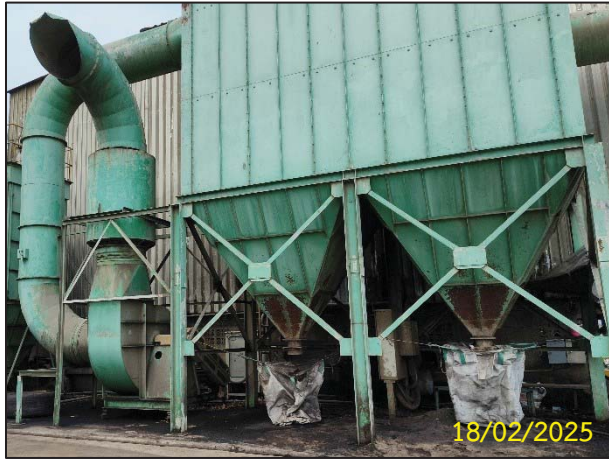
ติดตั้งอุปกรณ์ดักฝุ่นละอองหรืออุปกรณ์ช่วยลด การฟุ้งกระจายของฝุ่นสินค้า
